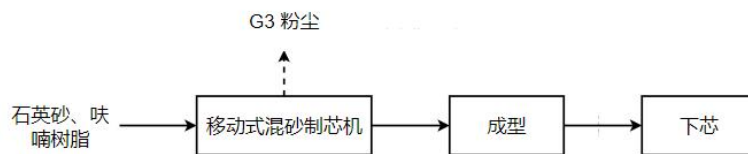
图 3.5-3 热芯工艺（含混砂）流程及产污环节示意图
